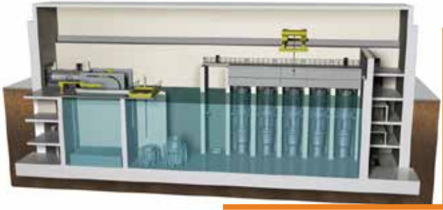
Şekil 3. Nükleer Modüler Reaktör kesit örneği (NuScale Power Reactors. ©NuScale Power, LLC, All Rights Reserved [6])
