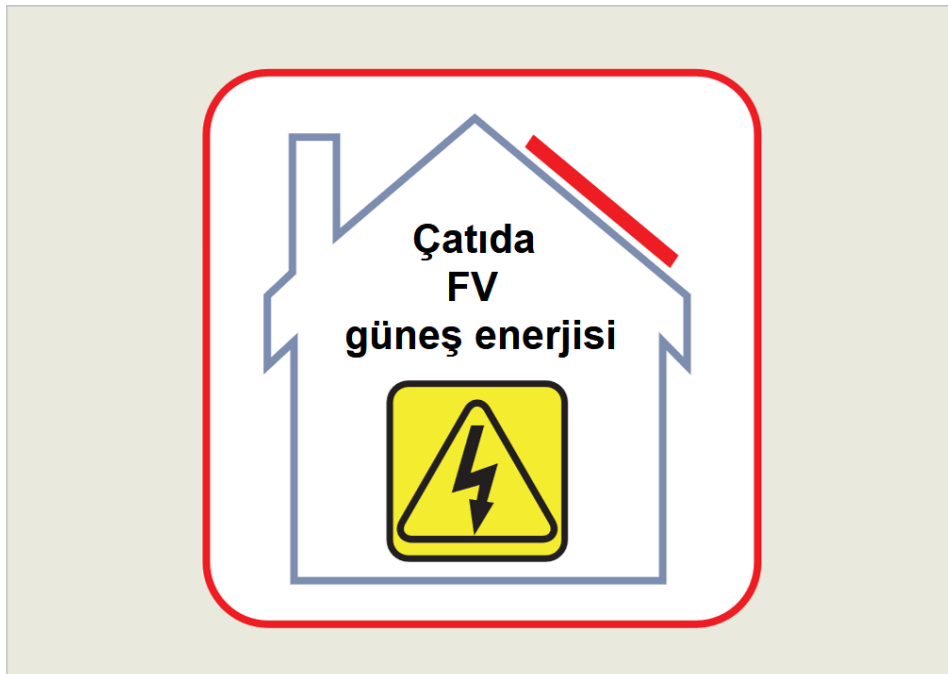
Şekil 11.16 Çatıda FV güneş enerjisi işreti
