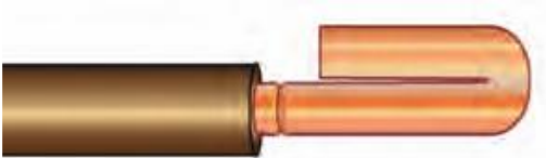
Şekil 6. Yalıtkanı sıyrılırken iletkenin zarar görmesi.
