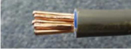
řekil 15. 16mm 2 7 damarlı kablonun baęlantıdan önce uygun ölçüde kesilmesi ve damarlarının yassılařtırılması.
