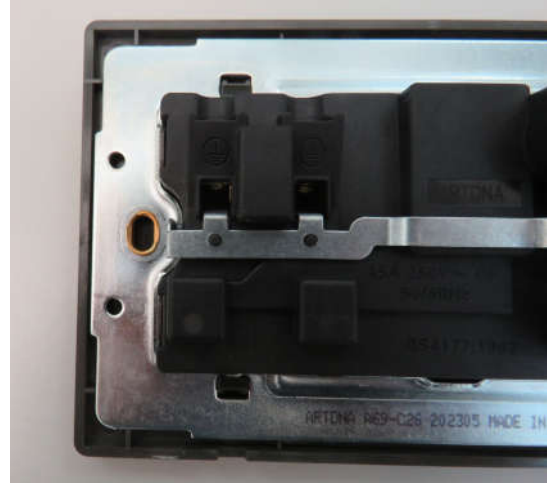
Şekil 4. Ürünün topraklama kuşaklaması ulaşılabilir dış iletken çerçeveye özel bir perçin ile tuturulmuş, topraklama sürekliliği sağlanmıştır.
