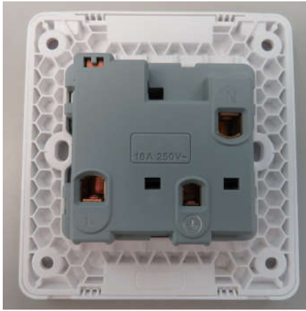
Şekil 1. İşaretleme Eksik (marking is missing) ✘
