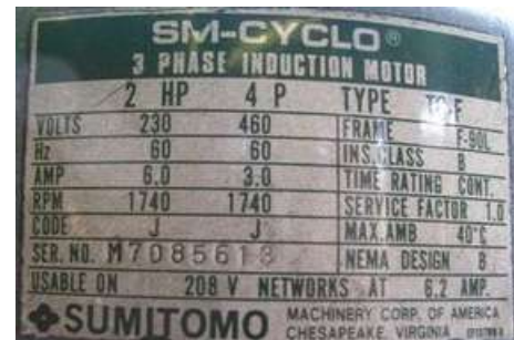
Çift gerilimli motor için örnek etiketler
