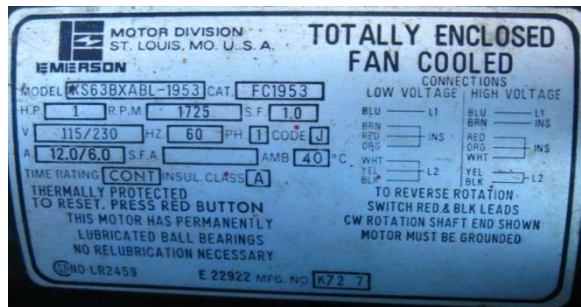
Çift gerilimli motor için örnek etiketler
